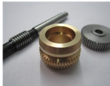
Червячная пара БрАЖ9-4 и 40Х13 ОАО «НПК «НИИДАР»
