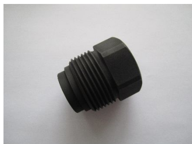
Корпус ПИГН.753128.016 Сталь 30ХГСА – МЗ.Хч
