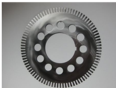
Лазерная резка 08пс ОАО «ELDIN» Диск ротора электродвигателя
