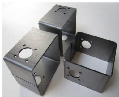
Лазерная резка и гибка Сталь 08пс АО «Красный Маяк» г. Ярославль
