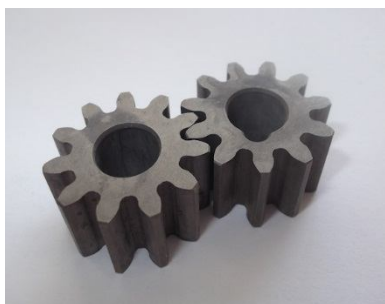
Шестерни 53.11060.040 АО «ЯЗДА» Группа ГАЗ (Азотирование)
